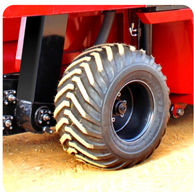
Eixo reforçado com pneus novos (balão) HF 75 com 16 lonas.
